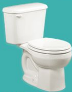
Inodoro Colony Redondo Blanco. 1.28 GPF. Tecnología PowerWash™ Válvula de salida de 3". No incluye asiento. 221DA004020.
